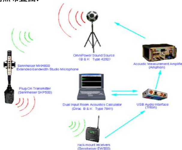
图8 建声测试仪器系统图
